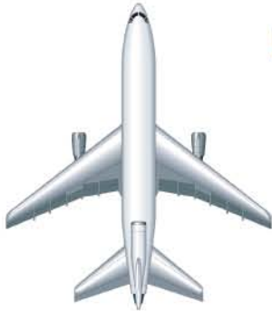
voilure F en flèche F swept-back wing ala F en flecha F Pfeilflügel M ala F a freccia F
